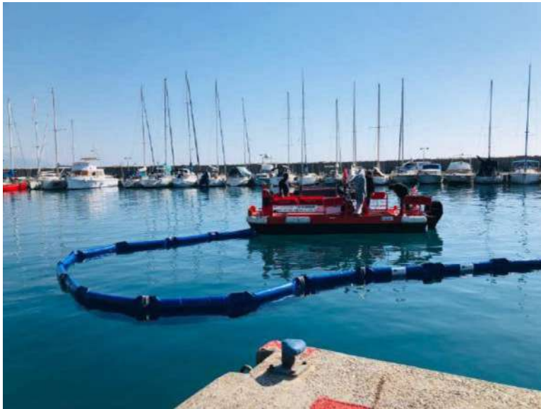
Déploiement d'un barrage de confinement
